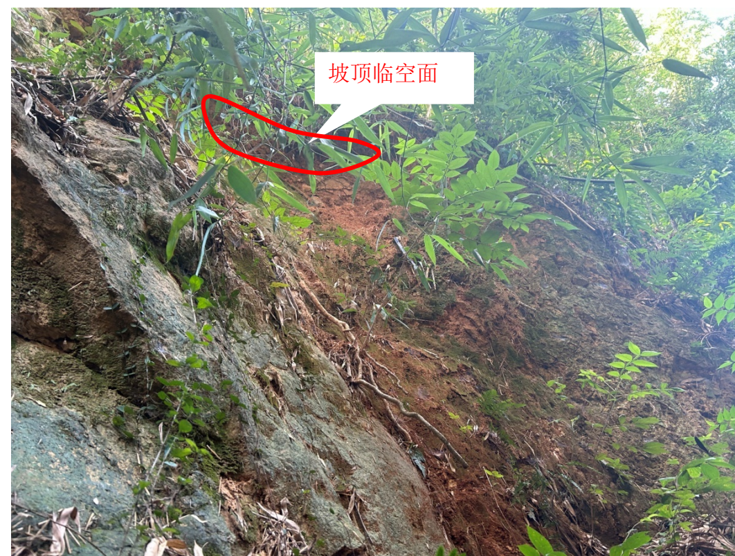
照片 2 勘查区 I 段边坡坡顶临空面照片位于地质调查点 D2 附近(镜向东)
